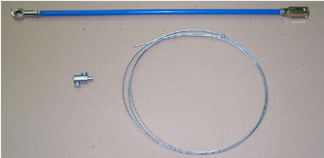
**La commande de freinage doit être isolée du châssis et montrer la double commande**
